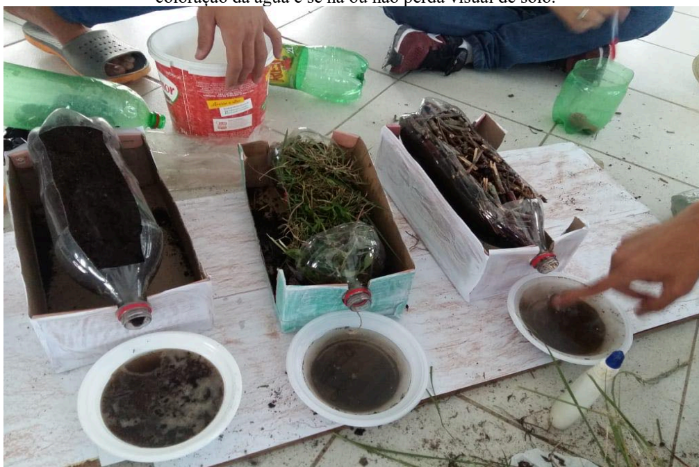
Figura 3. Resultado obtido do experimento sobre a importância da cobertura vegetal, deve-se observar a coloração da água e se há ou não perda visual de solo.
